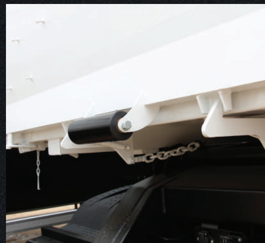
Porta traseira com rolete para rodotrem. Maior segurança no basculamento.
