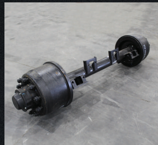
Eixos com capacidade técnica de 13 ton.
