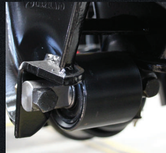
Buchas moleculares do braço tensor. Não desalinha.
