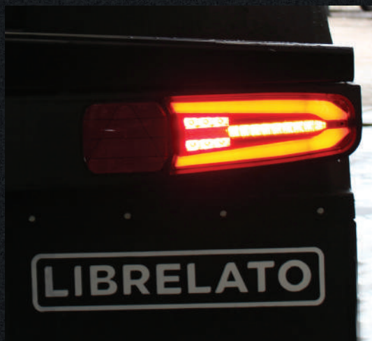
Lanterna traseira com design inspirado na linha automotiva e com indicação de direção sequencial.
