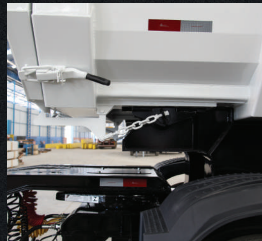
Acoplamento do dolly é feito sem ajuda de outra pessoa além do motorista.
