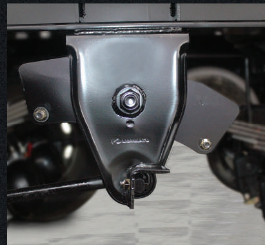
Balancim auto-lub. Não necessita de lubrificação.
