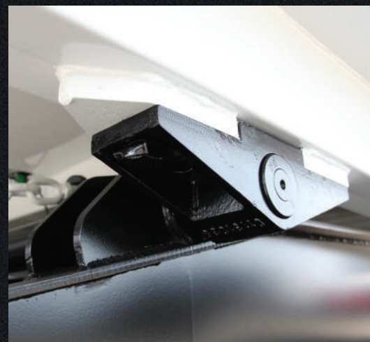
Mancal de giro com bucha auto lubrificante. Economia em manutenção.
