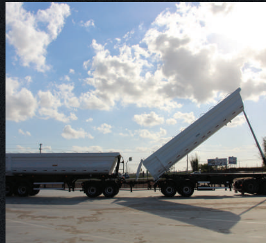
Maior angulação de basculamento. Semirreboque dianteiro com 40° de inclinação.
