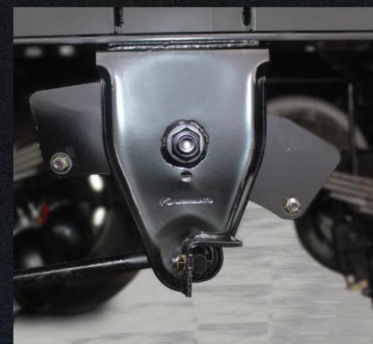
Balancim auto-lub. Não necessita de lubrificação.
