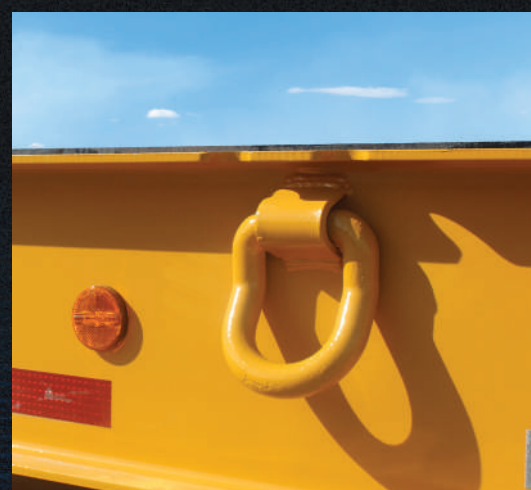
Argolas laterais reforçadas para melhor fixação da carga.
