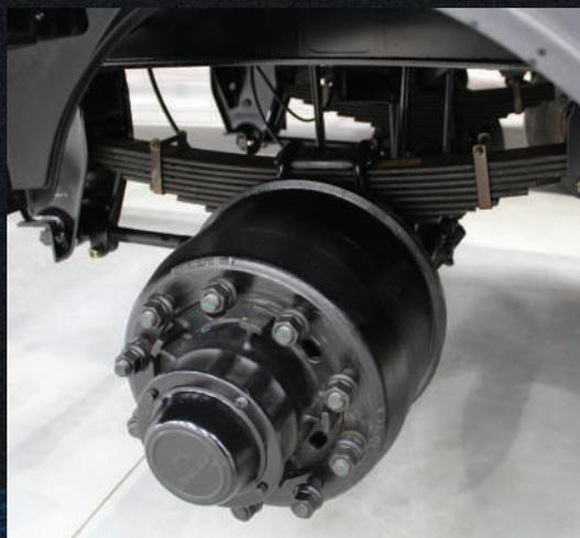
Eixos com cubo outboard e dois rolamentos grandes. Manutenção dos freios sem retirar o cubo do eixo
