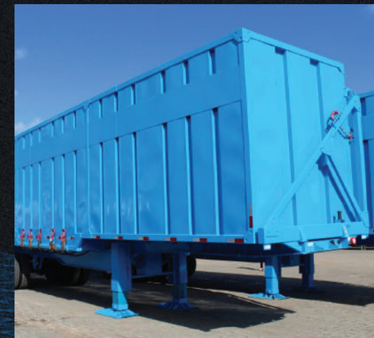
Caixa de carga em aço de alta resistência.
