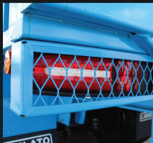
Sinaleira traseira com proteção metálica.
