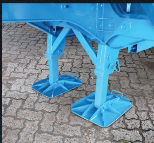
Sapata com acionamento pneumático. Opcional patola com acionamento eletro hidráulico.
