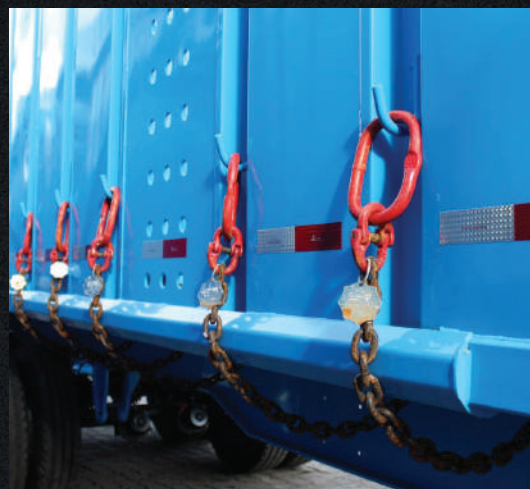
Correntes de içamento.
