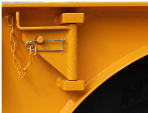
Alargador lateral de 100mm com opcional de 200mm na plataforma e rampa
