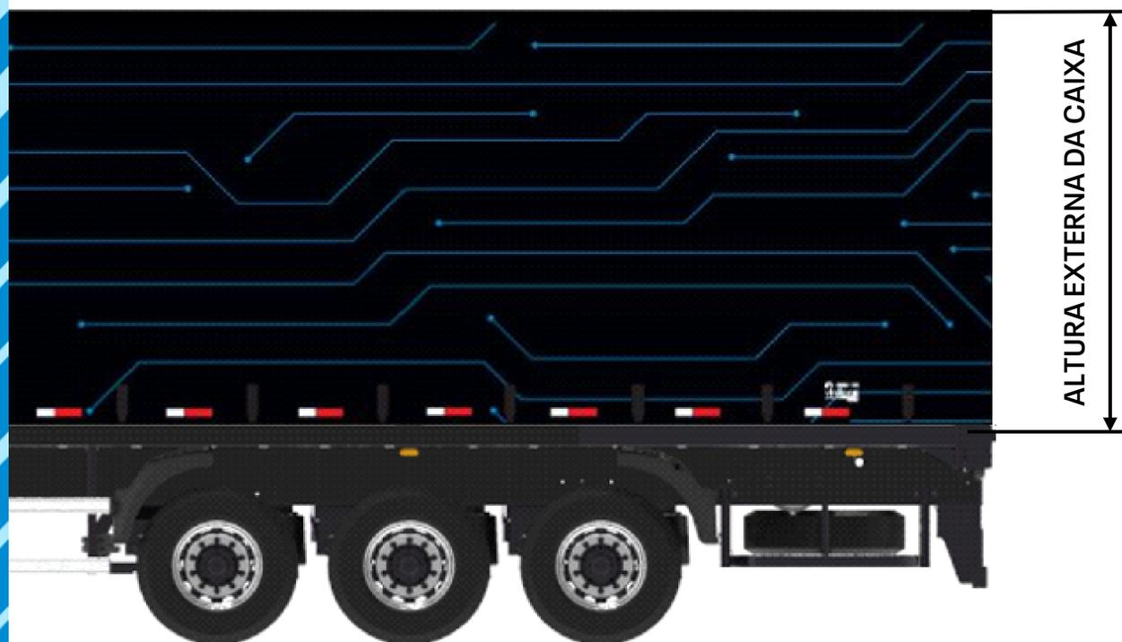
**IMPORTANTE:** para Bitrenção a altura máxima opcional é de 3000mm, por conta da suspensão deslizante do vagão dianteiro.
